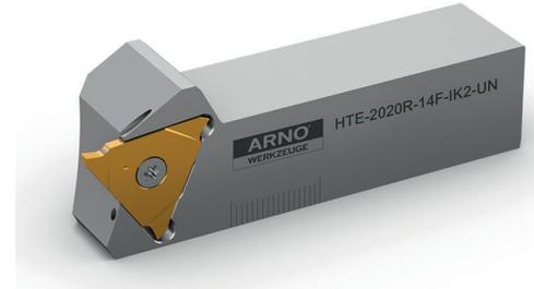
3 Bei diesem Halter des dreischneidigen ATS-Werkzeugsystems zum präzisen Abstechen von kleinen Bauteilen stellt eine versenkte Klemmschraube die stabile, genaue Klemmung an der geschliffenen Anlagefläche sicher © Arno
